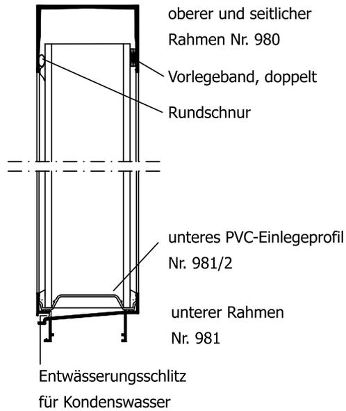
Rahmenprofile mit thermischer Trennung
