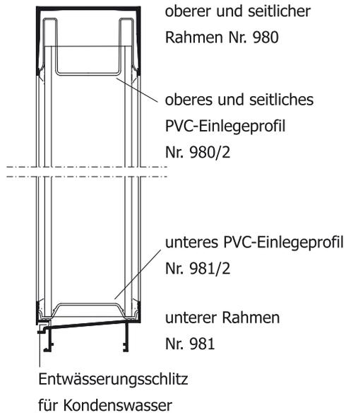
Rahmenprofile mit thermischer Trennung
